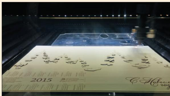
На этой фотографии вырезается сложный контур новогодней открытки. Плотность бумаги — 280 г/см<sup>3</sup>, скорость лазера — до 200 мм/мин., мощность — 22 ватта.
