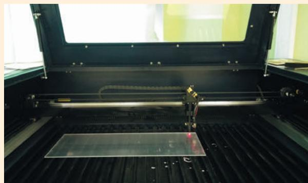
Шаговые двигатели перемещают этот рабочий орган по двум осям. Место реза обязательно охлаждается — иначе очень часто материал начнет гореть или испортится место обрезки. На самом деле от способа обдува многое зависит, — например, если нужно препятствовать горению, то обдувают не воздухом, а углекислым газом или азотом. Очень рекомендуется к таким станкам подключать вытяжку — иначе все очень быстро оказывается в дыму.
