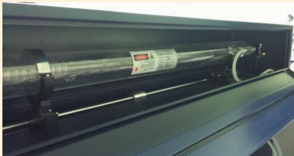
Обратите внимание — во время работы трубка должна быть закрыта, знак опасности на ней представлен не просто так. К трубке подведена дистиллированная вода — для охлаждения. Вода подается обычной помпой все время работы — иначе трубка перегреется и выйдет из строя (а это довольно дорогая часть станка).
